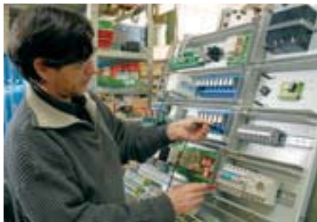
Alle Steuerungen werden abschließend nach einem (je nach Typ bis zu 21-seitigen) Prüfprotokoll auf Herz und Nieren getestet.
